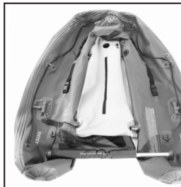
6. Εισαγάγετε τον «σωλήνα κύτους δαπέδου» με αφρό στη θήκη της άκρης του δαπέδου.
