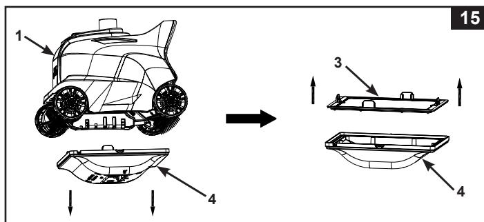
6. Συναρμολογήστε ξανά το δίχτυ υπολειμμάτων και τη βάση του αυτόματου καθαριστή, ακολουθώντας τα προηγούμενα βήματα με αντίστροφη σειρά.
